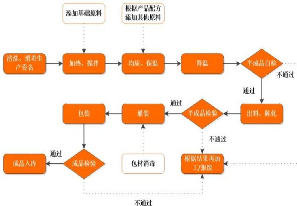
②面膜类产品生产过程主要包括料体乳化、面膜布叠膜、灌装、包装等环节，其工艺流程图如下：
