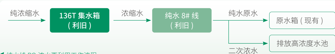
纯水线 RO 浓水再利用工作流程
