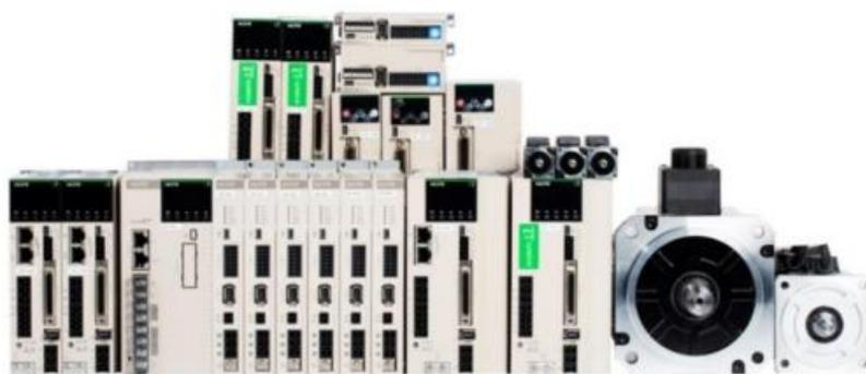
伺服系统由伺服驱动器发出信号给伺服电机驱动其转动，同时编码器将伺服电机的运动参数反馈给伺服驱动器，伺服驱动器再对信号进行汇总、分析、修正。整个工作过程通过闭环方式精
