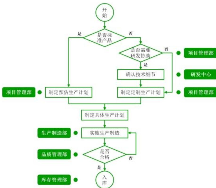
公司产品的基础生产工艺较为相似，包括贴片、插件、产品组装、老化测试、质检、包装等各项环节，根据公司自身特性设计出的柔性生产线工序能快速切换成不同产品的生产要求，有效降低生产成本，且生产计划部可以根据实际情况调整生产计划，调整周期可精确至天。因此，公司能利用有限的生产设施完成多种类、多型号产品的生产，提升生产效率，快速响应市场需求。
