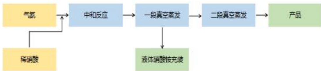
液体硝酸铵的生产工艺流程图
