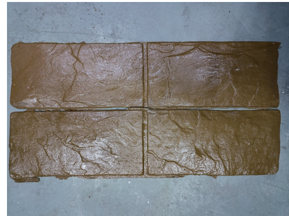
自研软瓷材料（经过表面处理）
