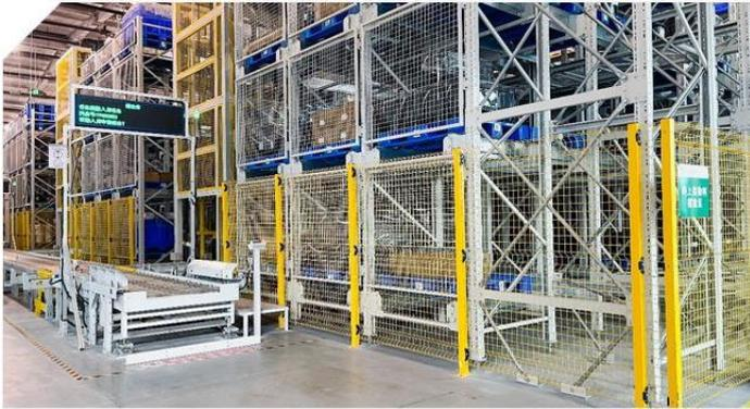
采用四向车加密集货架形式，可在水平方向四个方向运动，通过提升机进行立体换层。此项目整体规划充分利用场地空间，兼容场地中立柱和斜拉撑等障碍物，留有四个方向出口，同时兼容不同方向的出入需求。
