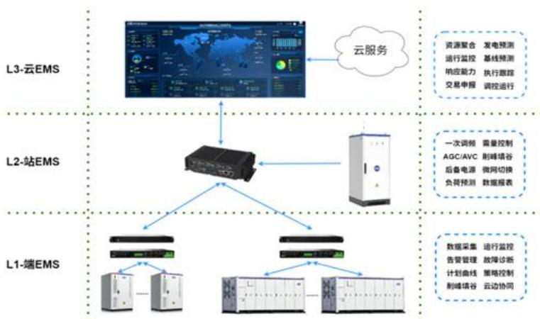
端、站、云三级架构 EMS：设备运维到电力交易的全方位管理
