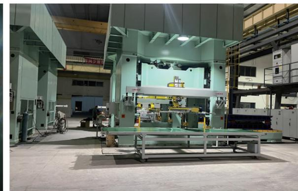
定制化储物箱冲压产线
