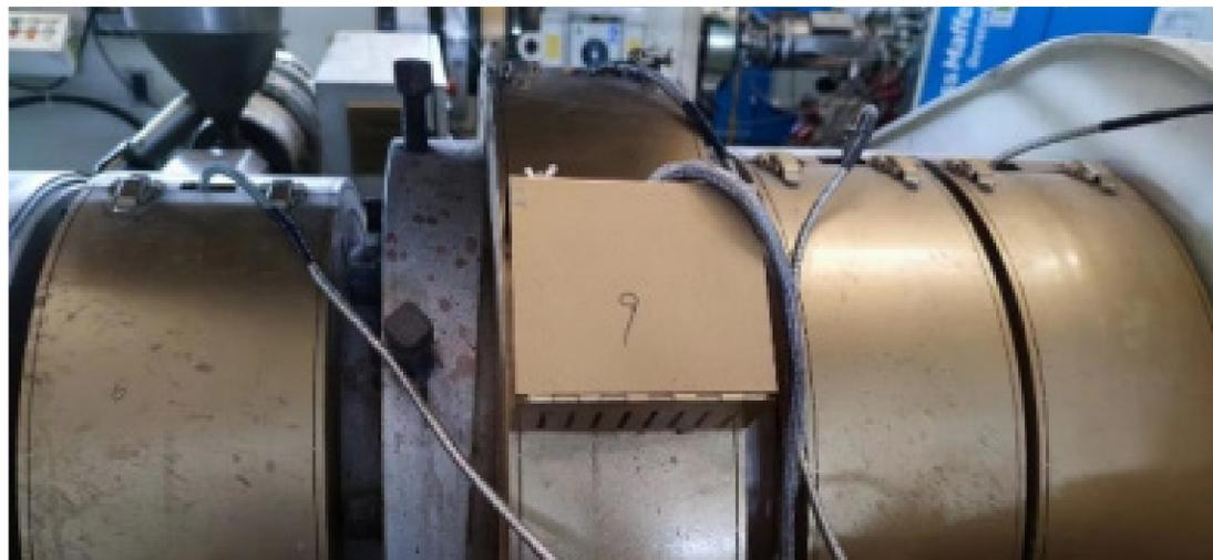
亚大市政管道板块亚大塑料、四川亚大、西安亚大、深圳亚大、上海亚大、海宁亚大 6 家公司投资 40 万元，在 25 条生产线上推广使用红外节能加热圈代替电阻加热，通过快速加热和隔热层，减少热损失，实现节能 5% 左右，年节约电能成本 30 万元。
