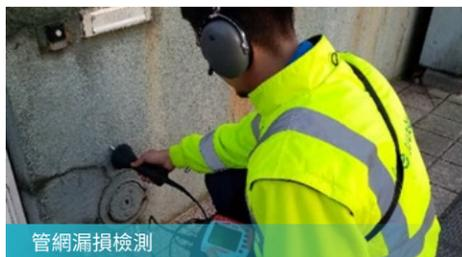
管網漏損檢測
