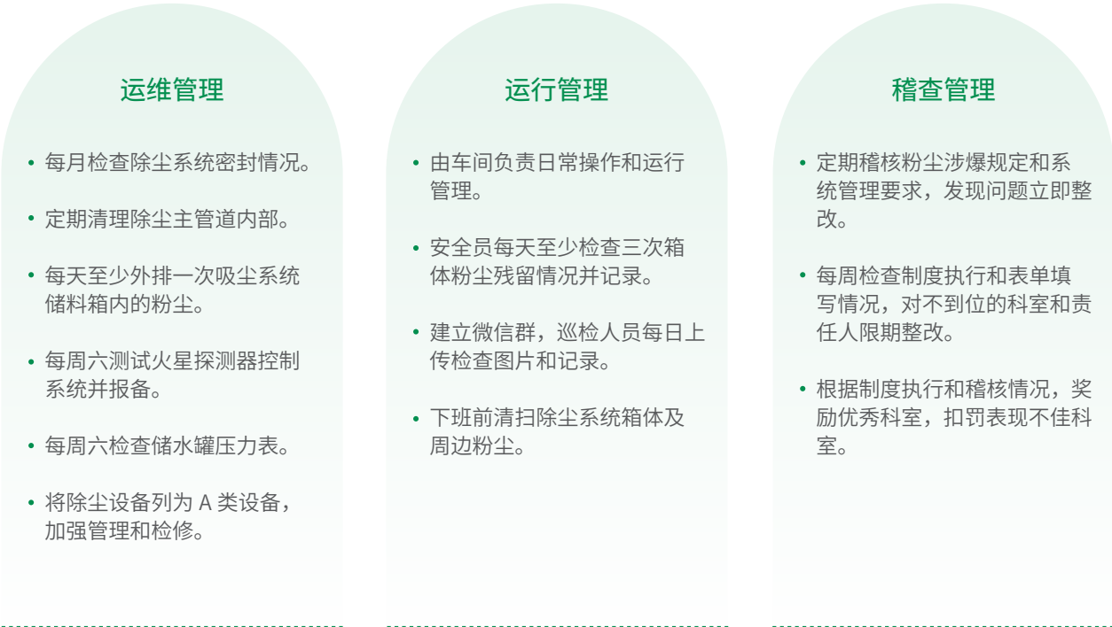
中央除尘系统管理规定
