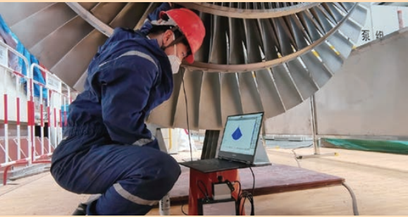
汽轮机叶片相控阵智能化检测
