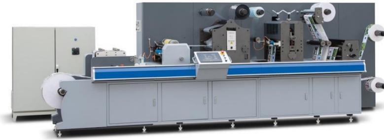
间歇·全轮转商标模切机采用圆压圆模切方式，速度最高可达 120 米/分钟。该机配备有先进的伺服控制系统，可按需要选配各种功能装置，完成放卷、纠偏、柔印上光、冷烫、覆膜、分条复卷等印刷及印后工序。
