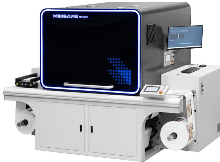
数码印刷机雅致系列相较于传统印刷机，采用了灵活高效的印刷配置，拓宽了客户的应用范围，兼顾高效率及作业方案灵活性。该机型印刷速度最高可达 60 米/分钟，印刷宽度达到 230 毫米，最大卷径 600 毫米，大卷径保证了打印的连续性，减少了停机收放料的频次和时间；采用 single-pass 方案，非接触式打印，无需制版可一次成型，同时印刷精度最高可达 1200\*600DPI，成像细腻色彩饱满，呈现更精致细腻的打印效果。再加上该机型搭载高精度压电喷头，独有的 VSDT 技术，可以自由控制喷射的墨滴大小，从而减小画面颗粒感，搭配专业的数码印刷墨水，可以使得产品颜色饱和艳丽，色域宽广，过渡性好，呈现更多画面细节、色彩过渡平滑，最终实现高速输出和高质量打印。该机型配备了除静电装置、除尘装置，保证了印刷品质始终如一，具备稳定可靠的印刷品质。数码印刷机支持网络连接和数字化管理，高集成软件能够实现快速接单、小批量生产、可变数据打印、打样等功能。
