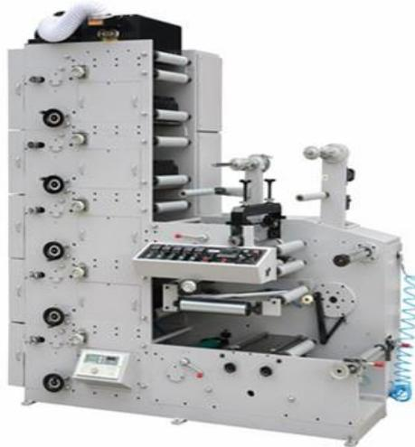
层叠式柔性版印刷机采用陶瓷网纹辊传墨，陶瓷层化学稳定性好，辊面耐腐蚀性佳，使用寿命长；网穴呈蜂巢状排布，吸墨性好，印刷效果好，可以进行高网线印刷，图案色调再现性好。该产品可根据需求添加选配模切工位、红外烘干装置等，能够实现从放卷、印刷、上光、自动红外烘干、覆膜、模切、收卷等工序的一次完成。
