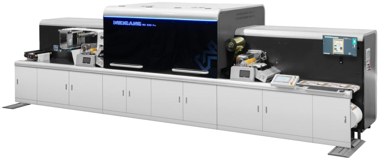
数码印刷机在外型上就明显区别于传统标签印刷机，它采用了简约、科技感的设计风格，给人一种年轻化、智能化、数字化的既视感。这款设备拥有灵活高效的印刷配置，在色彩组合方面非常灵活，可任意组合色彩以及增效方案；它可以兼顾高效率以及作业方案的灵活性，设备搭载了经久耐用的高精度压电喷头，可实现印刷品质始终如一的良好效果，而且支持全天候生产。印刷速度可达 60 米/分钟，印刷宽度可达 350 毫米，大大拓宽了用户的应用范围。设备采用的是 single-pass 喷墨方案，属于非接触式打印方式，一次成型、无需制版；印刷精度最高可达 1200\*600dpi，另外还有 900\*600、600\*600 精度模式可选，不仅成像细腻，而且色彩非常饱满；此外，数码印刷机采用英国 Hybrid Software 的 GGS 图形软件，全球首个基于 AI 智能的专利软件，色彩管理更加智能、方便、快捷。该机型引入柔性印刷技术，结合柔版印刷的优点，采用 CMYK+专色的应用系统，色彩还原度高，白墨光油还可实现各种数字增效应用，使得产品呈现更精致细腻的打印效果。
