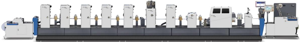
间歇式 PS 版商标印刷机（胶印）采用高品质重型胶印印刷单元，每个印刷单元由 20 根墨辊以及 4 根水辊组成，具有良好的传墨系统，能有效防止墨杠及鬼影现象的产生。同时，每一机组单元均由独立伺服电机驱动，各印刷单元调节横向和纵向移动均由独立电机控制，为机器在高速运转中的高精度套准提供了保证。该机型可以在不停机的情况下，在主控台上调节印刷品的横向和纵向套准，有效地提高了印刷品的质量和产能。
