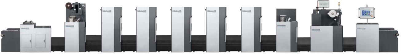
组合式高速全轮转（套筒）胶印机是公司在间歇式 PS 版商标印刷机（胶印）的技术储备基础之上，结合标签印刷市场发展趋势研制而成的最新产品。该产品创新性地研发出了可变径套筒式印刷滚筒，印刷图案长度与印版滚筒表面周长接近相等，可实现全轮转连续式印刷，解决了传统胶印机滚筒只能进行间歇式印刷的痛点，大幅提高了印刷速度，将最高印刷速度提高至 180 米/分钟。版滚筒和转印滚筒采用气胀套筒式，两个滚筒可根据印刷图案长度同时更换，适应不同长度尺寸图案的印刷，换版速度快，简单易操作，印刷效率高。该机型的传墨机构可以自动调整来适应版滚筒外径的变化，优化设计传墨路线，匀墨效果好，印刷压力平稳。配备的自动控墨装置可以实现一键式调节，墨量自动控制，精准供墨，提高了印刷精准度并减少了浪费。
