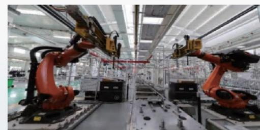
油底殼飛輪殼螺栓擰緊工作站
