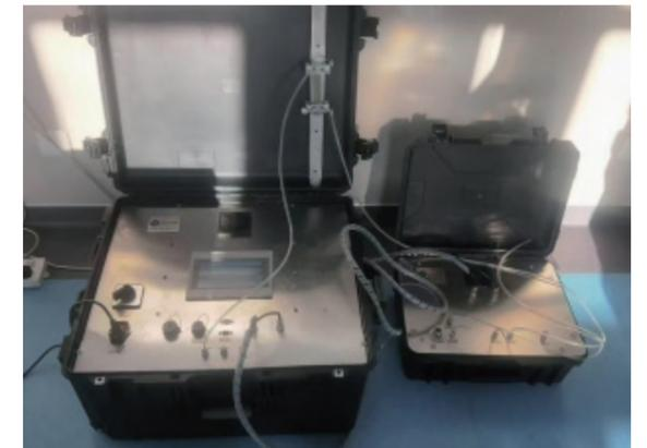
▲ 移動式溫室氣體在線監測設備
