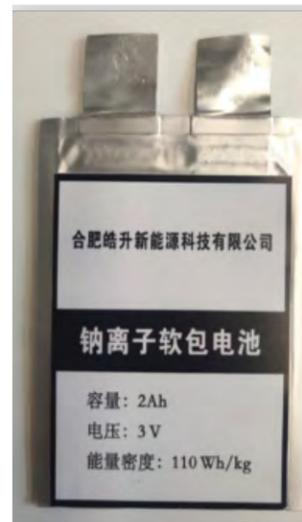
公司正极材料制成的软包电池
