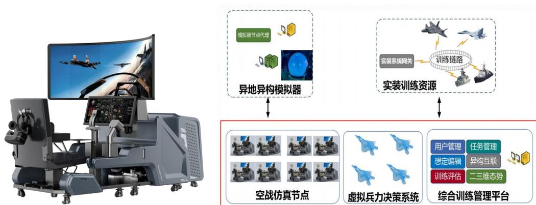
便携式通用数字空战仿真系统具有沉浸式虚拟训练环境、仿真 HOTAS、便携式座椅等设备，能够灵活配置节点数量，可以满足中远距空战、视距内格斗、空面打击、编队飞行、转场演练等仿真训练任务。便携式通用数字空战仿真系统已实现与实装飞机、虚拟兵力的LVC互联，并在多个演习任务中发挥重要作用。该产品目前已交付航空兵一线部队、试验训练基地、院校等单位，为提升部队战斗力发挥了重要作用。
