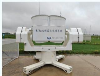
四创电子自主研发的W/Ka毫米波双频共面垂直指向偏振云雷达系统能够提供更高精度的云层结构和降水特性数据，提升了云降水微物理的探测能力。
