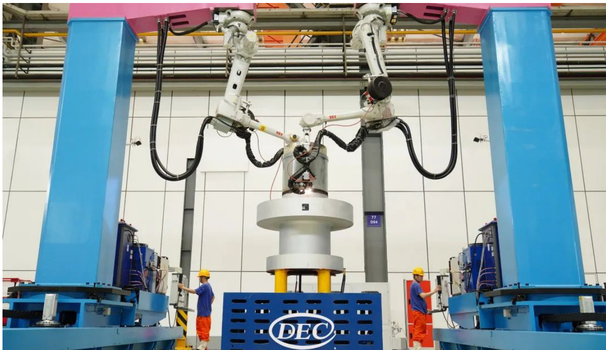
東方汽輪機建成國內首個綠色高效焊接數位化車間，實現焊材用量節約80%
