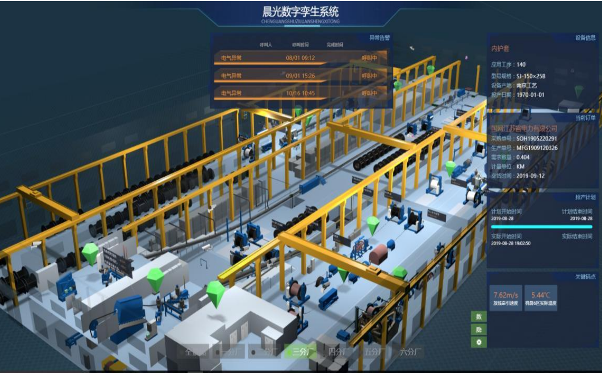
晨光电缆智能工厂、产线数字孪生系统
