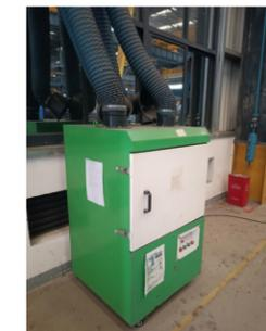
利用移动式除尘器实现焊接烟尘净化
