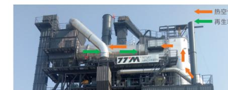
逆流再生加热技术示意图
