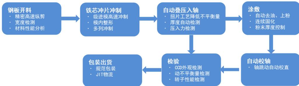
**(2) 微特电机转定子铁芯工艺流程图**
