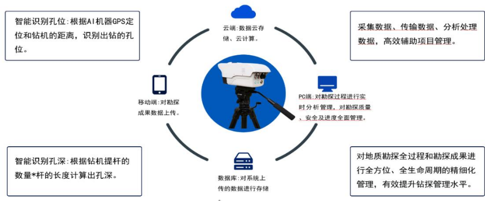
图：工程现场管理视觉机器人
