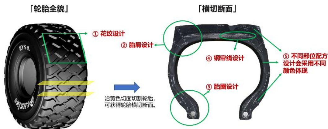
图 轮胎横切断面及设计要素示意
