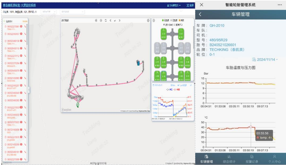
图 泰科仕轮胎智能管理系统 PC 端及移动端监控展示界面
