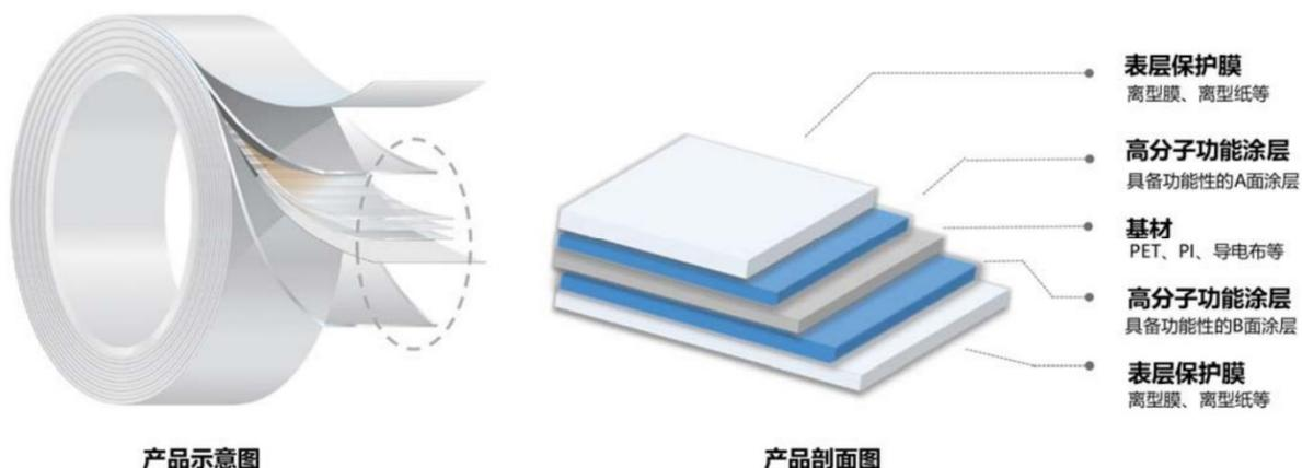
注：标的公司功能性涂层复合材料以高分子功能涂层为分类标准，分为单层、双层或多层复合结构，图示中结构为双层复合结构，由 A、B 双面高分子功能涂层、基材及表层离型膜组成
