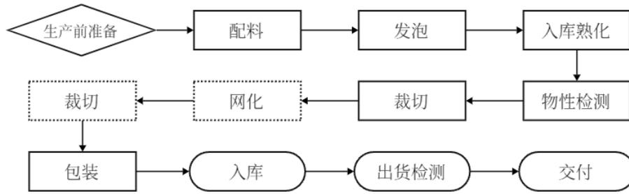
注：工艺流程图黑色虚线框内的工序仅为部分产品生产所需的工艺环节。
