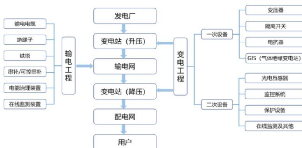
图：输配电及控制设备在输配电系统内的结构情况
