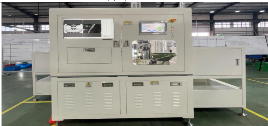
HBQ-G205 光伏连接器自动组装机 (长宽高: 2.8m*1.5m*2m)
