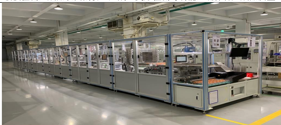
HBQ-K638 高压连接器柔性线 (长宽高: 16.5m*3.3m*2m)
