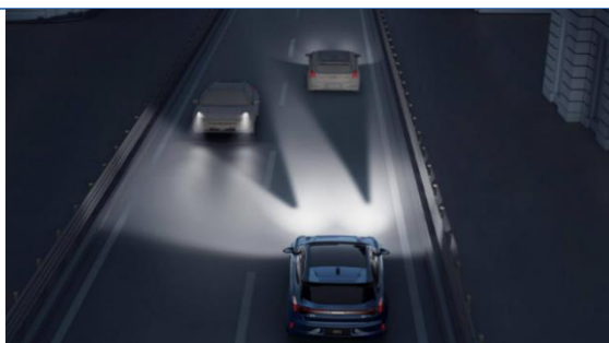
自适应远光灯系统（ADB）
