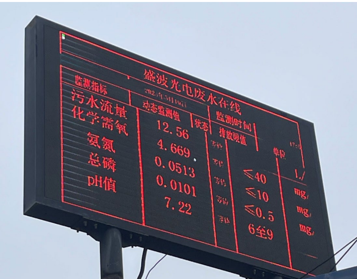
废水、废气在线实时监测系统
