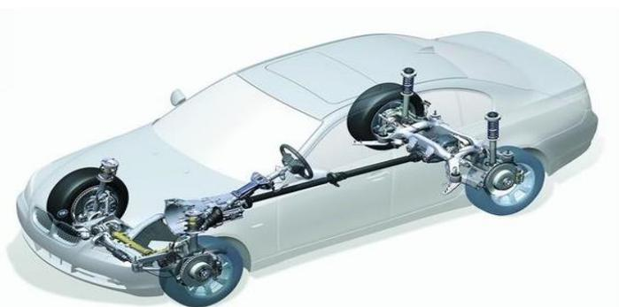
汽车底盘系统结构及车桥位置示意图
