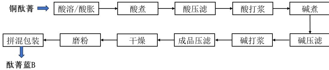
公司酞菁蓝 BGS 的生产工艺流程图如下：
