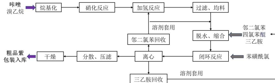
公司用自行生产的粗品紫进一步生产永固紫颜料的工艺流程图如下：
