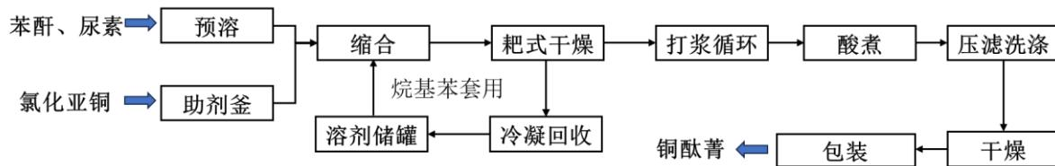
公司生产的酞菁蓝颜料主要包括酞菁蓝 B 和酞菁蓝 BGS 两类。其中，酞菁蓝 B 所采用的生产工艺流程图如下：
