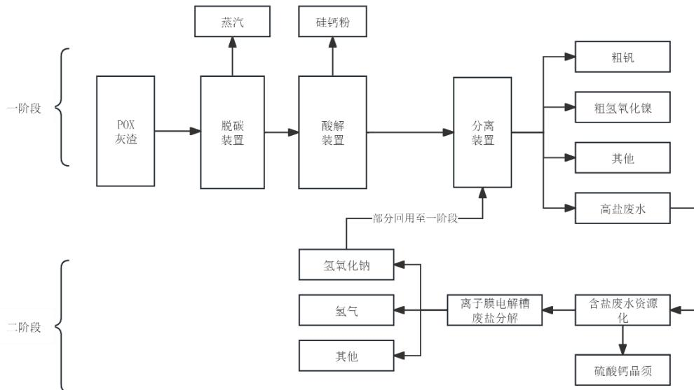
项目一主要包含含盐废水资源化、离子膜电解槽废盐分解两个工序。具体情况如下：
