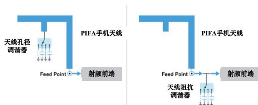
图：天线调谐开关（孔径调谐器、阻抗调谐器）在射频电路的位置
