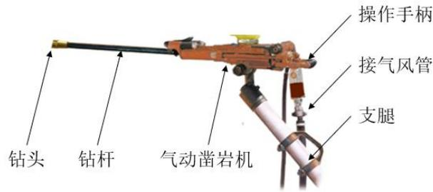
手风钻是量大面广的手持类半机械化产品。其操作维修方便、价格低廉，但凿孔速度慢、孔径小、孔深浅、作业噪声大、占用人员多、效率低、劳动强度大、容易发生机械人身事故和顶板安全等事故。
