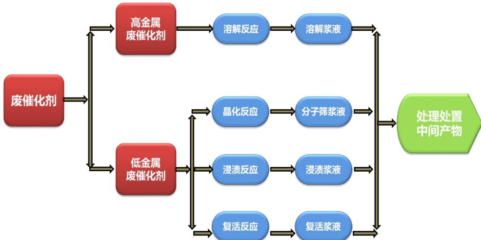
公司于每月下旬制定次月的处置计划，安排废催化剂的资源化综合利用工作。公司根据生产计划进行危废处置，从开始投料至反应完毕约 4 小时。处置时，由生产车间填写《危险废物出库单》，办理领料手续，将危险废物投入升温反应炉，以浸渍、复活、晶化等反应方式生成反应浆液，完成危险废物的无害化处置过程。此时，达到了危险废物处理处置服务的收入确认条件，同时结转成本。
