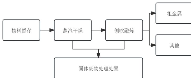
项目二主要包含蒸汽干燥、侧吹熔炼等工序，具体情况如下：
