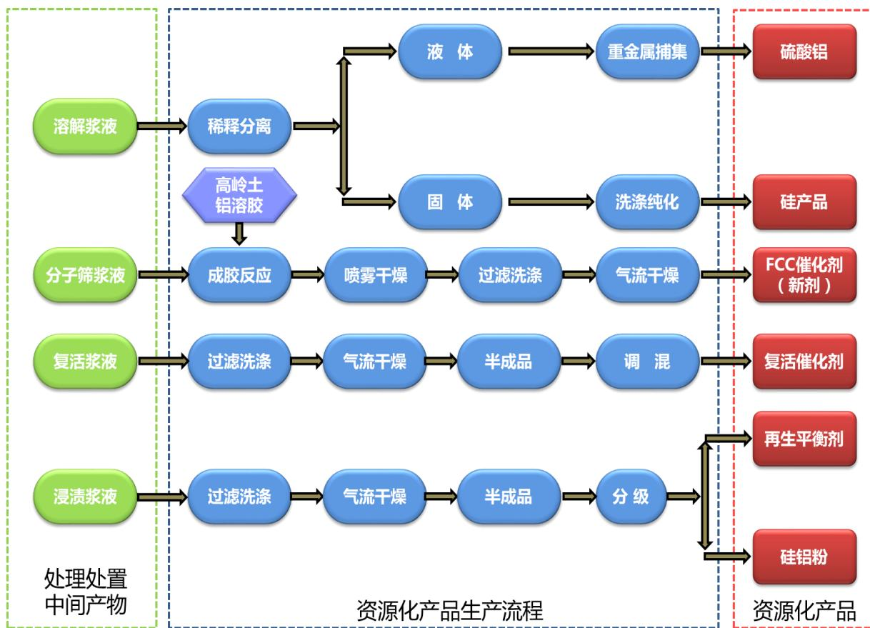
以废催化剂处理处置反应后的浆液为原材料，通过过滤洗涤，去除其中的金属及其它杂质，形成滤饼；利用气流干燥将滤饼中的水分去除，产出半成品；根据客户的需求，通过调混、分级生产符合客户要求的复活剂、再生平衡剂、硅铝粉产品；部分浆液添加高岭土等原材料，经过分子筛制备、改性、成胶、喷雾、过滤、洗涤、气流干燥等生产过程可用于生产 FCC 催化剂（新剂）。
