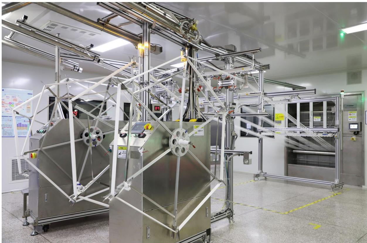
图 3 中空纤维血液透析膜纺丝线
