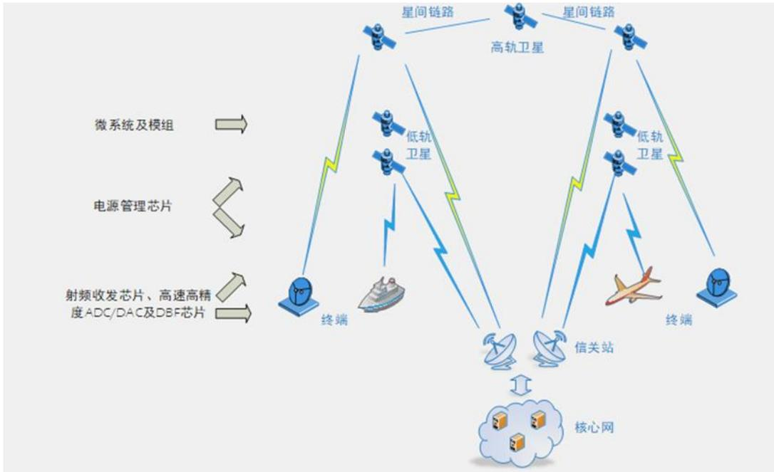
公司各类产品应用在卫星载荷/终端系统中的原理示意图如下：
