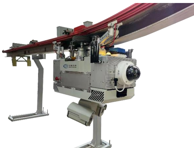
图 17、极寒轨道式智能巡检机器人
