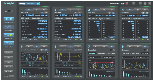
图：误码分析仪实时监控示意图
