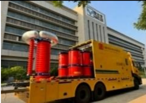
55kV 高压试验车
