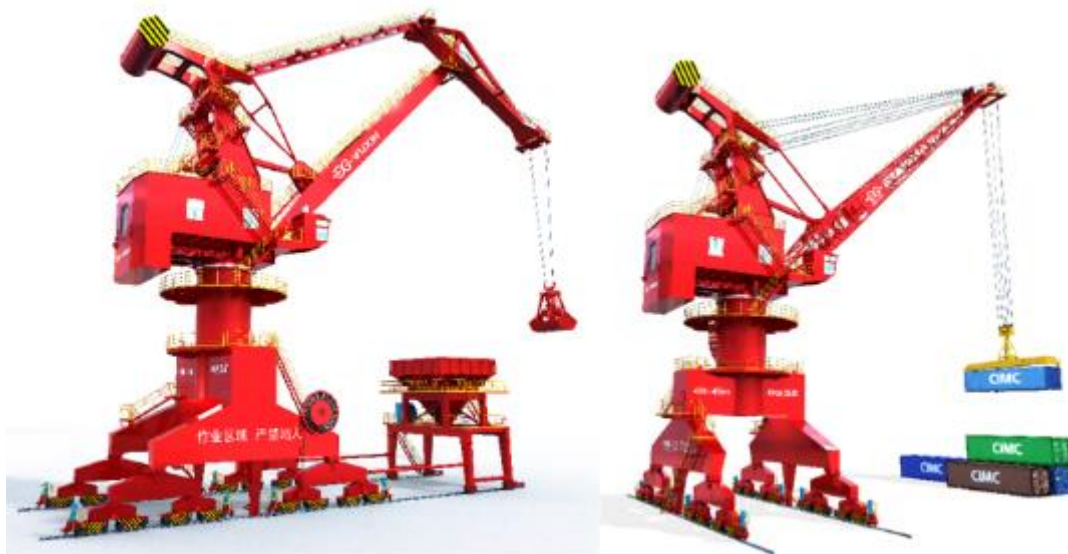
图：四连杆/单臂架门座式起重机
