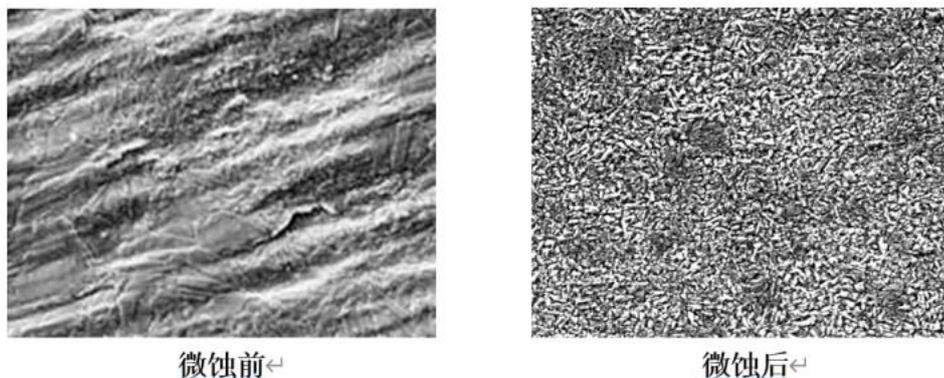
d、一般电子电路可以采用酸性微蚀产品进行表面处理，但对于某些特殊的材料，不适合采用酸性微蚀产品进行表面处理。如软板在做 OSP 时（有机可焊性保护剂，表面处理的一种方法），酸性微蚀药水对镀镍钢片的镍层存在一定程度的腐蚀，导致 OSP 后钢片发白，造成批量性的报废。公司开发出碱性微蚀产品，在碱性环境下对铜面微蚀清洁，不会腐蚀镀镍钢片镍层。
