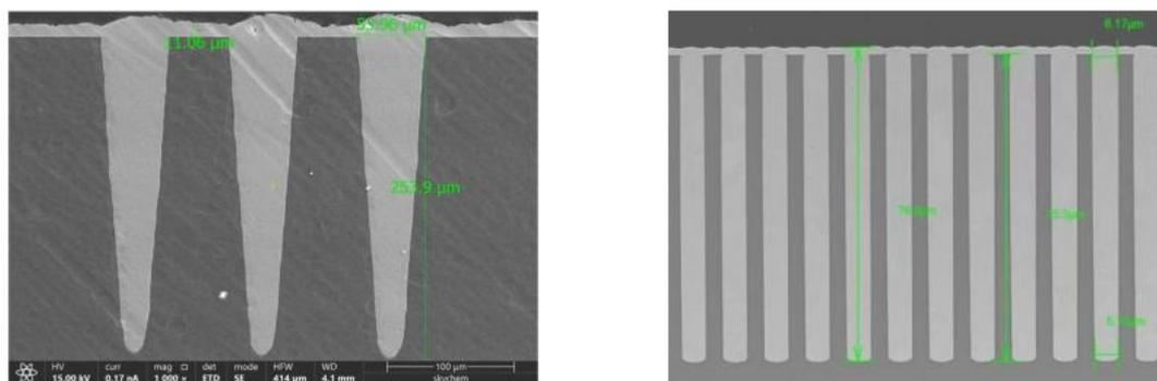
孔径50 μm，深度250 μm，AR~5
