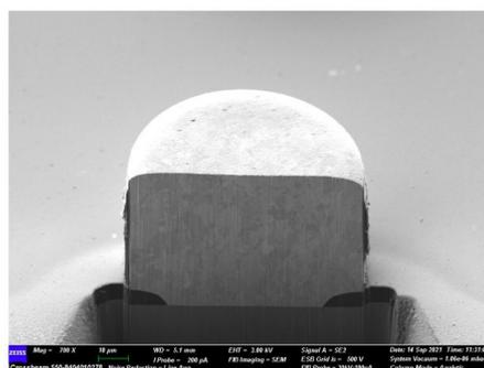
铜柱沉积电流：6ASD (5 μm)
