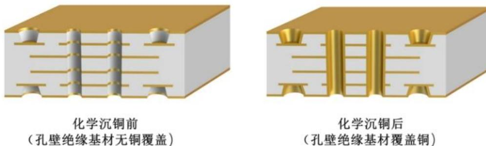
随着品质、技术和环保需求的驱动，中国大陆印制线路板厂商逐步采用水平沉铜工艺替代垂直沉铜工艺。与此同时，水平沉铜专用化学品成为沉铜制程使用的主流材料。
