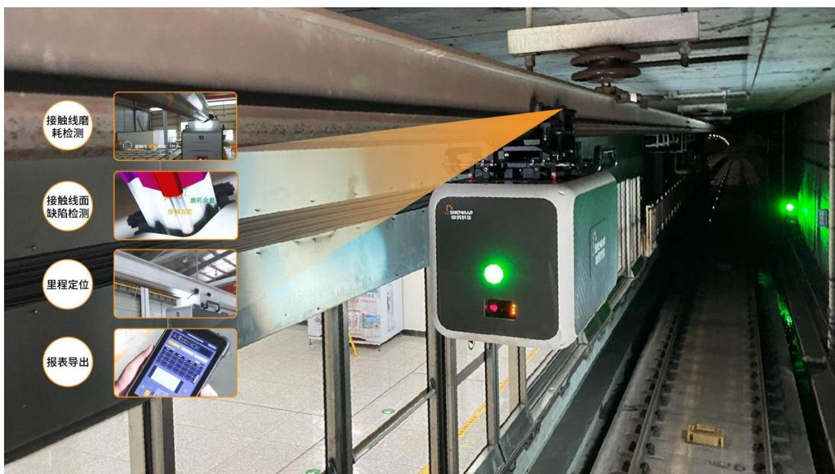
公司刚性接触网巡检机器人运行在刚性接触网汇流排上，能够对刚性接触网接触面宽、磨耗余量、偏磨角度进行高精度测量，对接触线表面拉丝等表面伤损缺陷进行识别定位。
