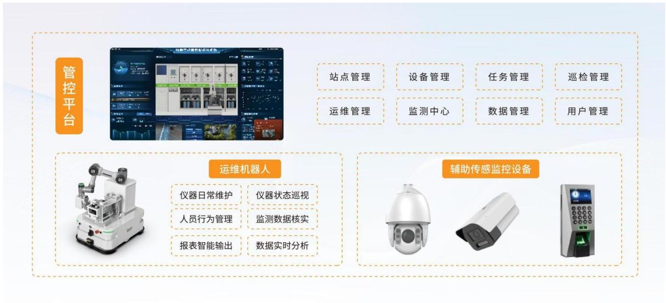
公司环保运维作业机器人运行于生态环境站房中，可实现自主运维巡视、自主运维监督，并辅助、代替人工实现试剂自动更换、电极自动清洗等运维任务。
