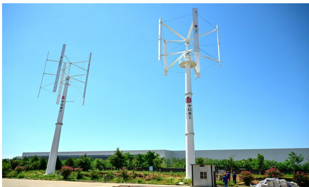
图示：中信重工研制的 50kW 垂直轴风机
