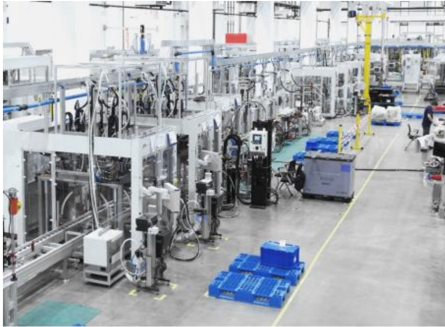
图：三合一电驱的装配和测试系统
