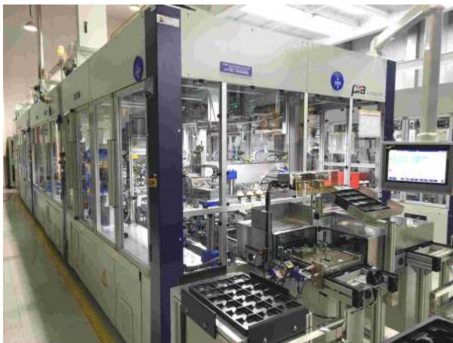
图：4D 毫米波雷达的装配与检测线
