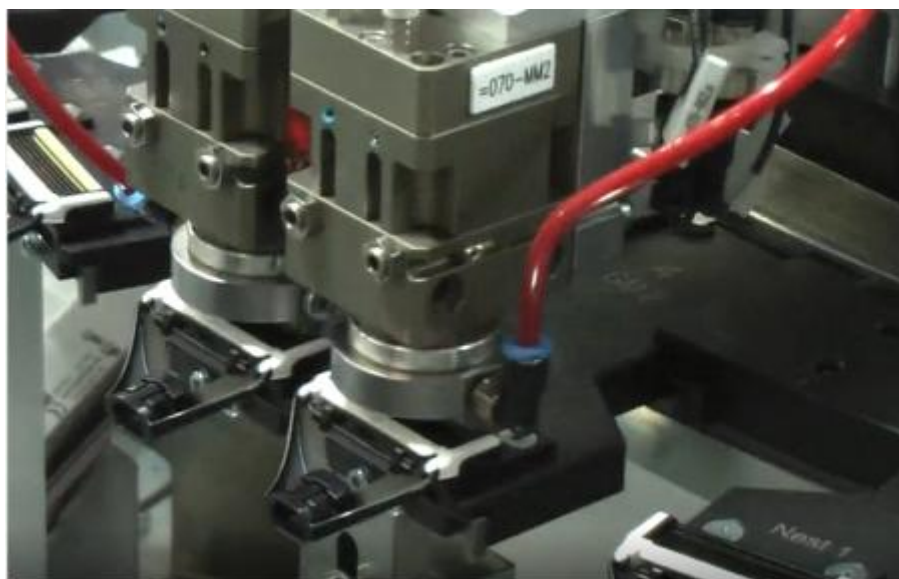
图：湿式剃须刀五层刀头装配线系统
