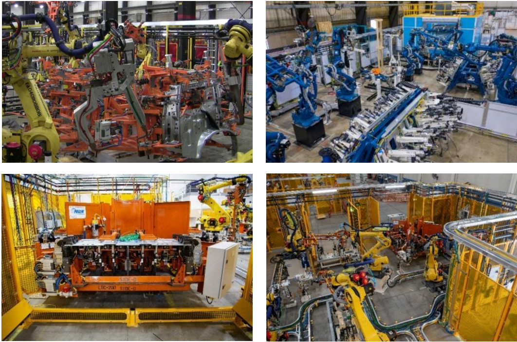
图 1.车身焊装自动化生产线
