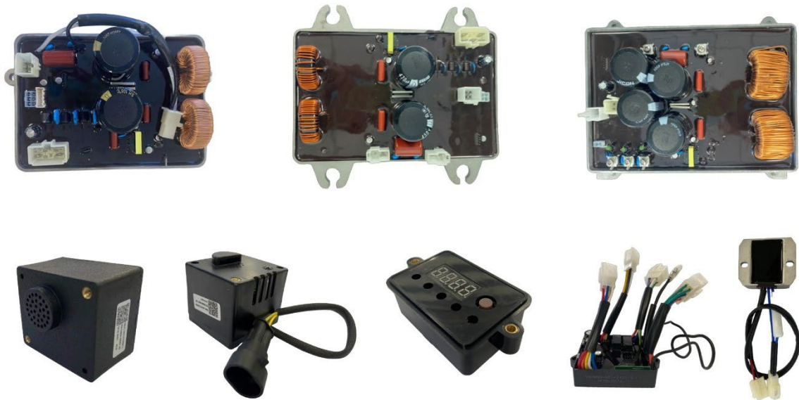
图四：发电机逆变器及附属模块
