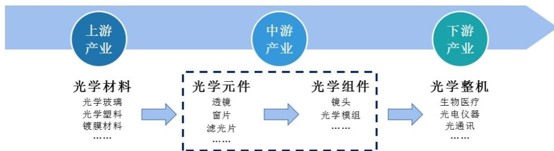
在光学产业链中，处于上游的各类光学加工设备、光学检测设备结构复杂，涉及机械、电子、自动控制等多个学科和领域，产品价值较高。目前全球市场的高端装备主要由日本、美国、德国供应，国内装备企业在努力追赶，部分装备已接近国际先进水平，但在产品精度、效率等方面还有待进一步提高。处于下游的各类光学整机产品种类繁多，且设计复杂、精度高、更新换代快，虽然整体价值较高，但涉及技术领域较多，且需要品牌建设和较强的资金实力。处于中游的精密光学元组件兼具技术密集和劳动密集特点，在产业链中相对附加值较低，部分中低端产品受劳动力成本影响较大，目前生产企业主要集中在中国大陆以及部分东南亚国家。
